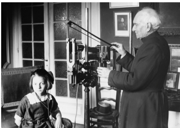
Figure 1 : a. Grand tonomètre de Koenig acquis par Rousselot et le docteur Natier servant à déterminer le champ auditif de personnes malentendantes ; b. Rousselot faisant la rééducation d'une petite sourde au moyen d'un résonateur amplifiant les sons de diapasons (© Jacques Boyer / Roger-Viollet).
